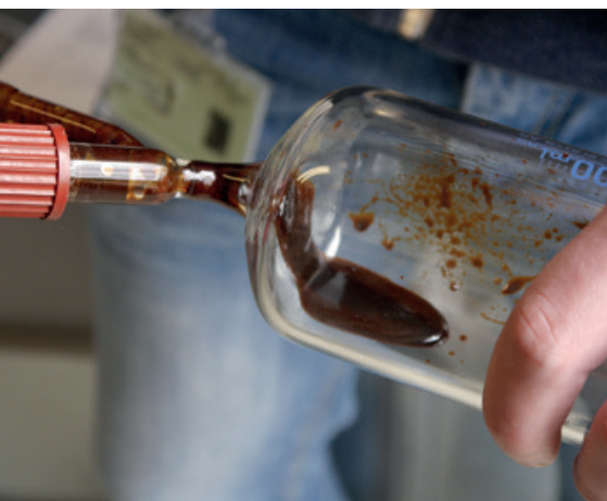
Abb. 7: Probenahme des verdampften Flüssiggases vor der Konditionierung des Biogases
